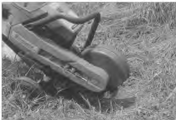
Husqvarna portable stump grinder
